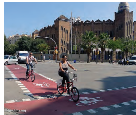
在交叉口醒目的标示自行车道，这样司机在拐弯的时候就会特别注意到自行车了。西班牙 巴塞罗那
