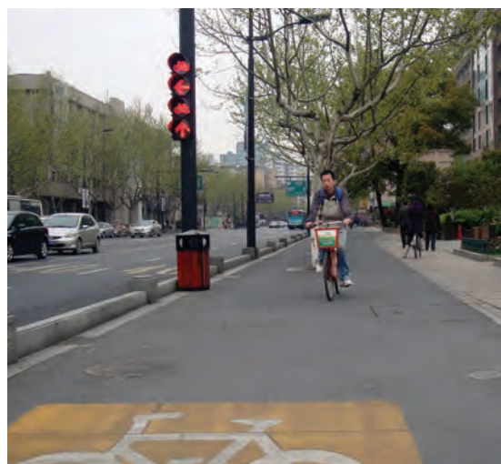
醒目的自行车道标志以及独立的自行车信号灯提高了骑行者的安全。
